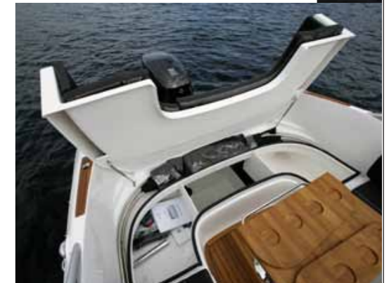
GOD ADKOMST: Hele sofaseksjonen akter kan heves slik at man får førsteklasses adkomst til store stuverom og teknisk avdeling under motorbrønnen.
